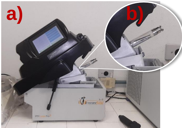
Figura 2: a) Moedor Criogênico (Freezer/Mill 6770). b) Frasco de moagem selado e em seguida imerso em nitrogênio líquido (LN).
