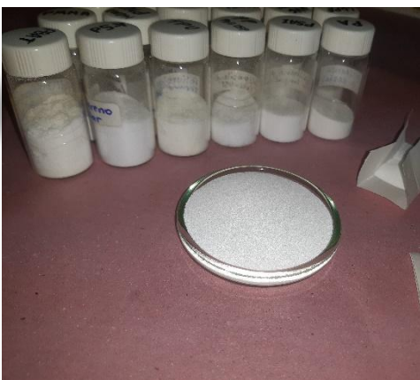
Figura 3: Plástico moído, pronto para fazer pacotes e serem irradiado.
