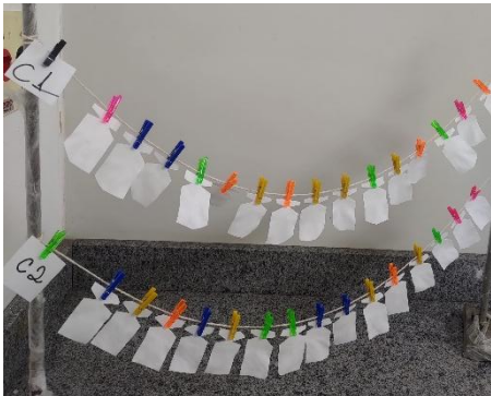
Figura 4: Secagem da solução-padrão em tiras de papel de filtro.
